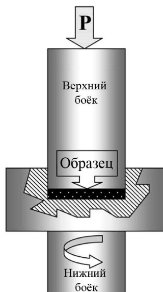
Рисунок 7 - Схема кручения под высоким давлением.
